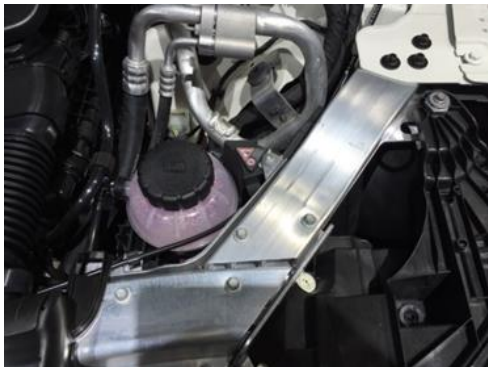
写真 20 Benz AMG E53 Cabriolet (ラジエーターサポートアッパーとエプロンメンバにアルミ押出型材適用)
