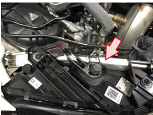
写真 21 Benz AMG GLA45 (エプロンメンバにアルミ押出型材適用)
