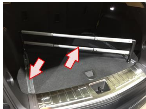
写真17 キャデラック XT5 トランク内の可動式伸縮仕切り装置
