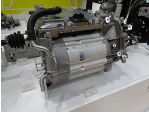
写真 3.4.7 アクスルドライブシステム (コンチネンタル・オートモーティブ)
