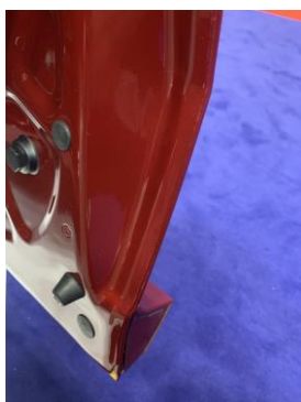
写真 3.2.2 ALPINA XD4 サイドドアレーザー溶接
