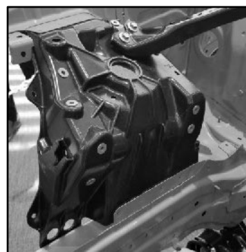
写真 23 ショックタワー (アルミニウム)
