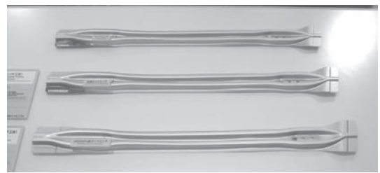
写真 52 ダイクエンチドドアビーム (アイシン, 鋼製)
