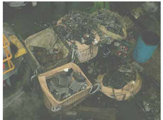
写真8．取り外されたハーネス類・熱交換器類
