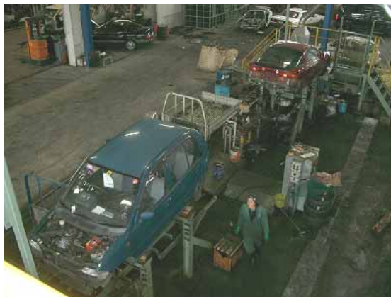
写真3. 液類回収作業の様子
