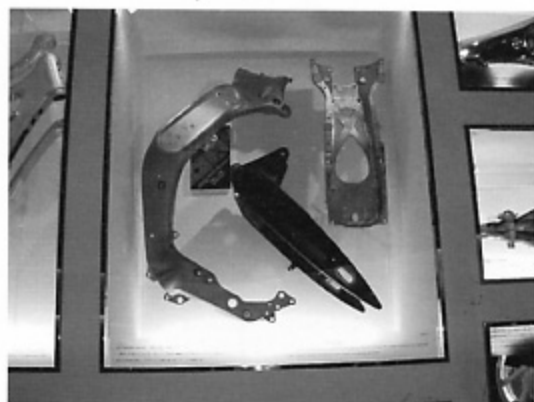
写真51 ヤマハ 大型ダイカストフレーム
