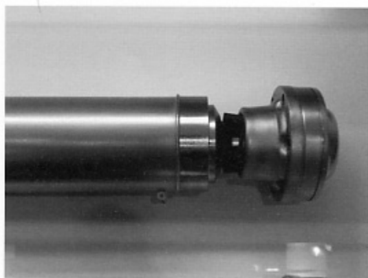
写真45 アルミ/スチール接合プロペラシャフト（日立）
